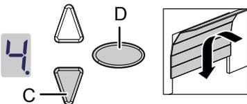
Abb. 12: Einstellung der Endposition ZU
