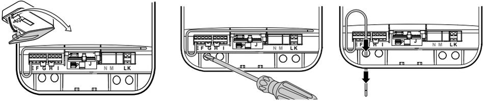
Abb. 7: Antenne verlegen
