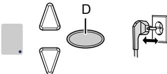
Abb. 10: Löschen aller am Antrieb programmierten Handsender
